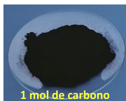
Figura 4.3: Ilustración de 12 g de carbono puro.
